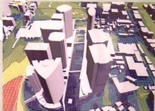
品川駅東口地区を対象とした解析結果 風速比と速度ベクトル分布
