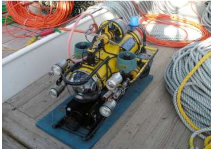
自走式水中テレビシステム 「ROV」
