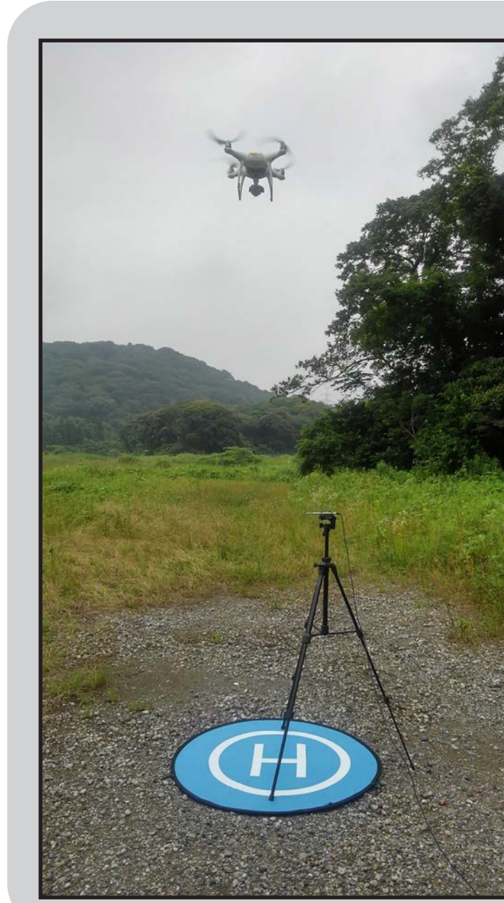
UAVの高度別ダウンウォッシュ風速 (左: 実験風景、上: 実験結果)
