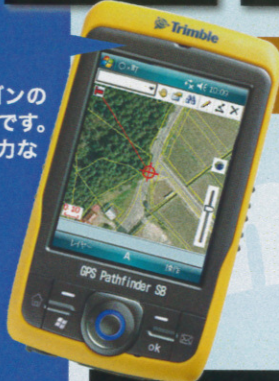
動作ハードウェア 例) ニコン・トリプル GPS Pathfinder SB mobile application
