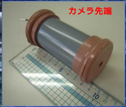
写真 2 (株)オオバの工夫事例 : 緊急巣内確認カメラ(ER カメラ)
