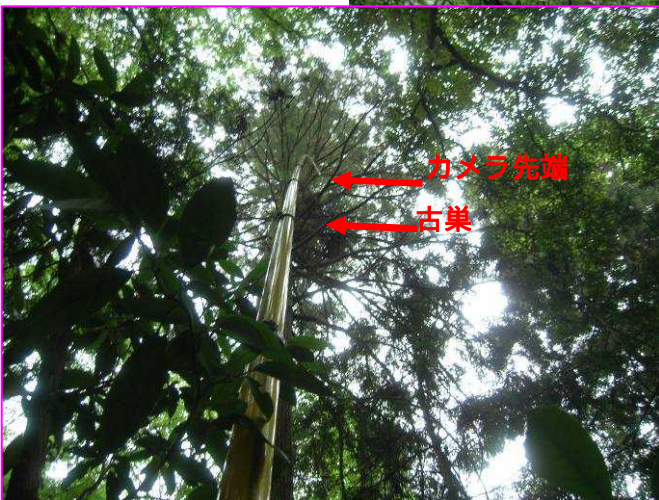
写真 2 (株)オオバの工夫事例 : 緊急巣内確認カメラ(ER カメラ)
