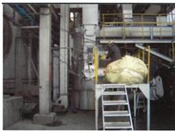
溶融炉のアスベスト廃棄物専用投入口にステージを設置、廃石綿等の入ったフレコンバッグを準備する。
