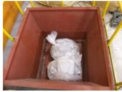
投入口は、投入設備種の5階床面に設置されており、中サイズ袋であれば一度に2,3個を投入可能。大袋もそのまま投入可能。
