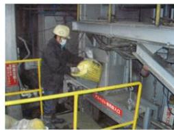
フレコンバッグから、2重袋詰めされた廃石綿等の袋を取り出し、専用投入口から1つづつ溶融炉に投入する。
