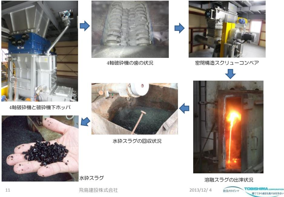
4軸破碎機と破碎機下ホッパ
