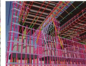
BIM/CIMデータ 背筋モデル(下部工)
