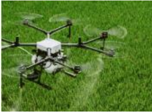
ピンポイント 農薬散布ドローン
