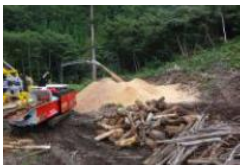
バイオマス燃料を山土場で 効率的に生産する移動式チップパー
