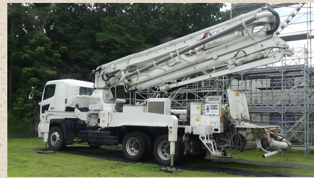
コンクリートポンプ車
