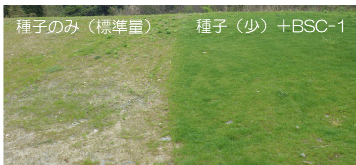
施工から2年経過しても植生侵入のない従来型の自然侵入促進工に対して植生侵入を促した例
