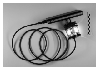
図-2 モバイルバッテリーで使用可能な高出力の紫外線LED球を使用した「LepiLED」（ドイツ製）
