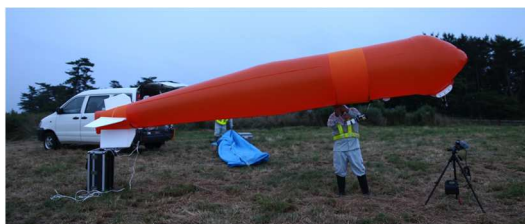
図1 飛翔高度調査に用いたバルーン
